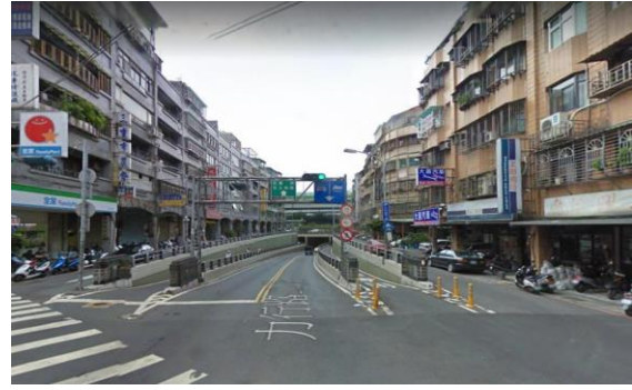
圖 10.6 新北市三重區力行路地下道之車道配置(1 禁行機車道、1 機車專用道)
